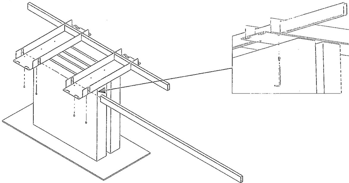
Schritt 2 / Montage Stirnbleche an Stabilisierungsrohre
