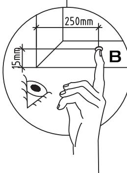
**Nach dem Stromanschluß misst der Sensor sein Umfeld ein und es kann erst nach ca. 30 Sekunden geschaltet werden**
